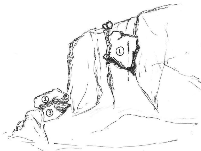
Bild 14. Skiss över kilblock (1) och block (2 & 3) i riskzonen, vy mot norr.
