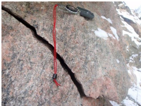
Bild 17. Blocket har redan rört sig en aning
